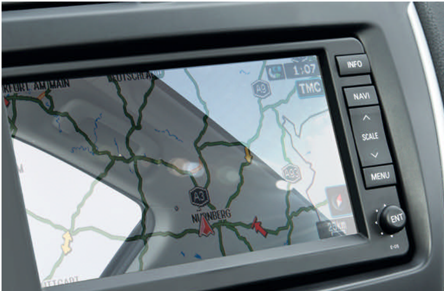
Bild 1. Nicht entspiegelte Oberflächen von Bordinstrumenten im Auto reflektieren das Licht und beeinträchtigen die einwandfreie Sicht beim Fahren
