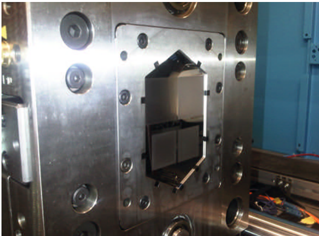
Bild 7. Kerneinsatz mit vier unterschiedlichen Versuchsfeldern im Cover- Form-Werkzeug einer Spritzprägemaschine (Foto: Evonik)
